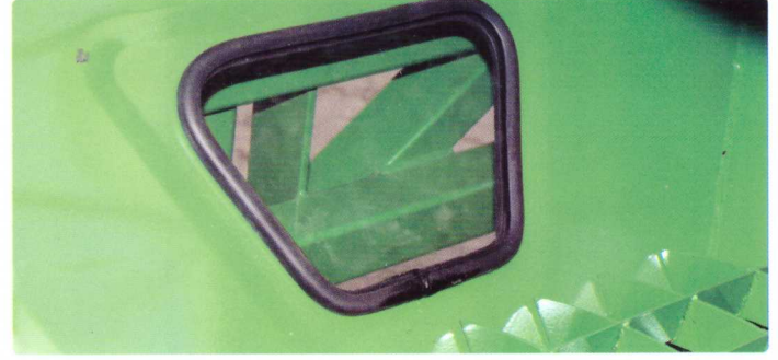
Gübre Seviye Göstergesi Fertilizer quantity indicator
